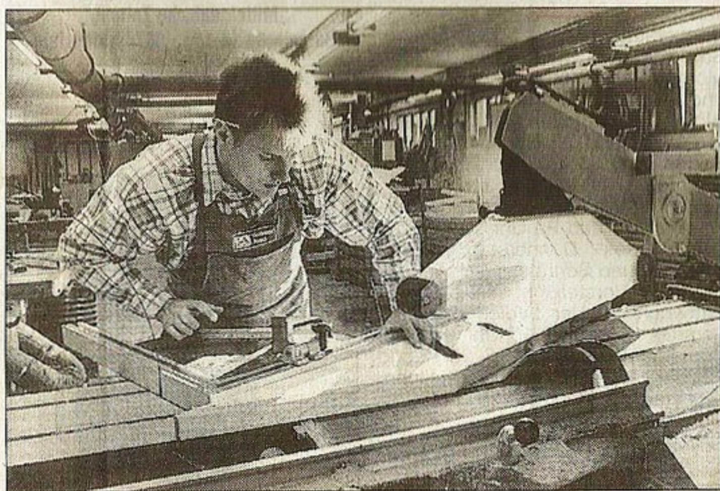
Wilko Turich bringt auf der Formatkreissäge leichtes, elastisches Eschenholz in die Form, welche es braucht, um als Bootgerüst dienen zu können
