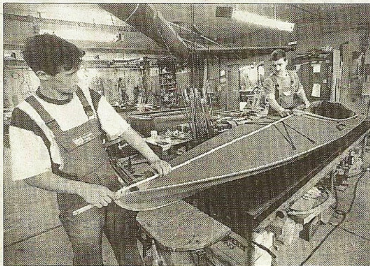
An der Abrichte arbeitet Günter Wiesalla. Das Skelett der Boote wird aus Holz gefertigt. Foto: S. Reinke
