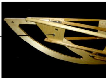
Spant 1 wird in die vordere Spitze am unteren Stevan eingeklappt und rechts u. links an den Bordwänden mit den Klappbeschlägen verbunden. Anschließend werden die Firstleisten ausgeklappt und in die oberen Aussparungen des Spant 1 eingelegt.
