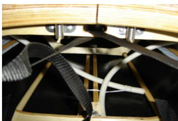
Verbinden der Rückenlehne mit Gurtband und Spanner zu Spant 5
