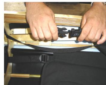
Verbinden der Rückenlehne mit Gurtband und Schnalle über Spant 4
