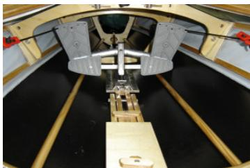
Eingesetzter Steuerbock auf der Aluschiene.
