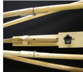
Verriegelung mit dem Aluschieber und festgeschraubt mit der Sternschraube
