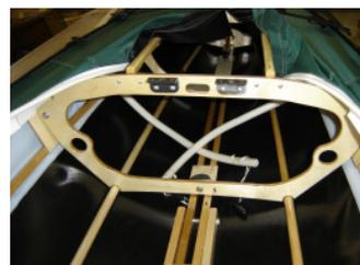
Einsetzen des Spant 5
