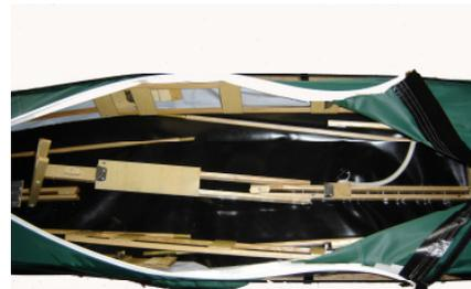
Hintere Bodenleiter wird in den Stift der vorderen Bodenleiter eingelegt und ist dann in der aufgeklappten Stellung wie im Bild zu sehen.
