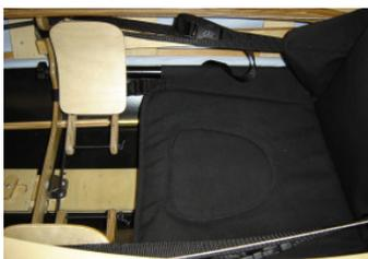
Als Zubehör gibt es eine Schenkelstütze die ebenfalls mit über die Alurohre geschoben wird und über Gummizug dann hält
